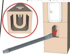
**1.8c.** In via esclusiva per le condutture di gas di scarico in sovrappressione ERLUS SÜ, per il tubo interno di diametro di 8 cm è disponibile come optional un condotto di ritorno del condensato (integrato nel pezzo di collegamento dei gas di scarico).
