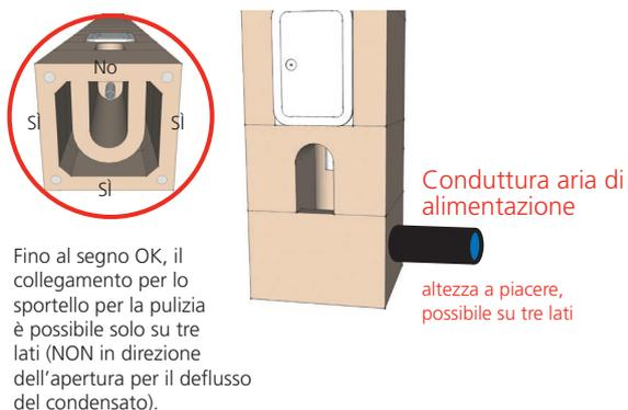
Fino al segno OK, il collegamento per lo sportello per la pulizia è possibile solo su tre lati (NON in direzione dell'apertura per il deflusso del condensato).
