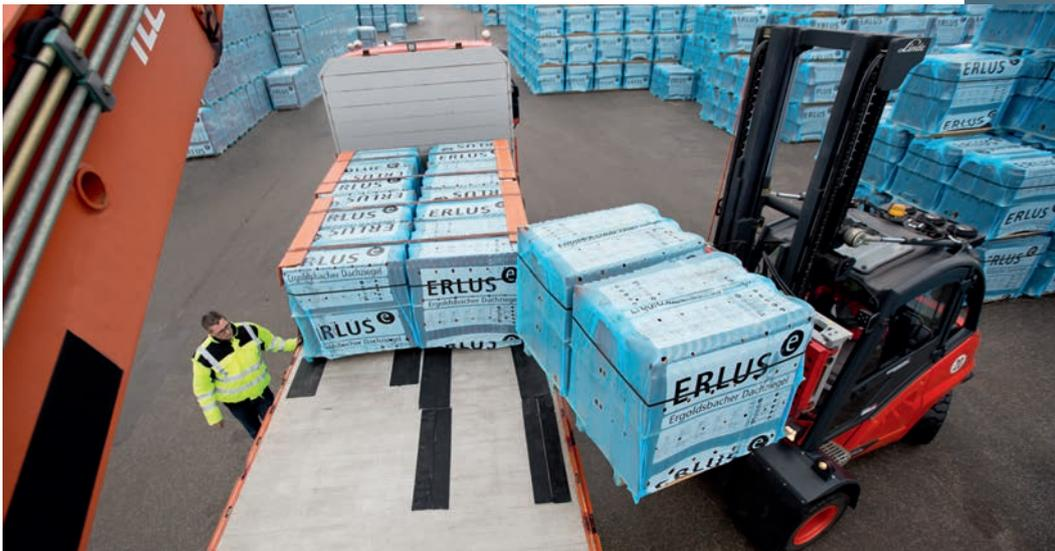
Reflektierende Sicherheitsweste, Antirutschmatten und richtiges Zurrmaterial sorgen für ein sicheres Verladen.
