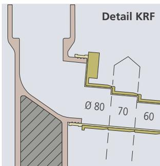
Die im Durchmesser 8 cm optional erhältliche ERLUS Kondensatrückführung (KRF) ist speziell für die Überdruckabgasleitung erhältlich. Mit ihr wird das Kondensat durch das Brennwertgerät entsorgt.
