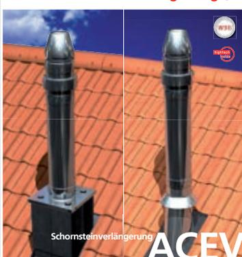
Optional kann eine ACEV-Schornsteinverlängerung für Überdruckabgasleitungen eingesetzt werden (bei zweizügigen Anlagen nur mit mittig liegendem Installationsschacht). Anstelle der VK-Abdeckplatte (09) wird eine Edelstahl-Übergangsplatte geliefert, auf die der Edelstahlmantel mit Edelkeramikinnenrohr montiert wird. In diesem Fall ist zwingend das Vorhandensein des Statiksetz BS erforderlich (s. Seite 12). Der Wechsel kann über oder im Dach erfolgen.
